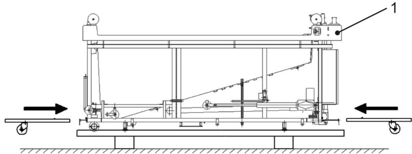
б) поднять ванну с рамой и направляющими роликами над поддоном, извлечь поддон;
