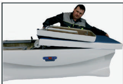
Фото 5. Снятие секций кушетки при техническом обслуживании
