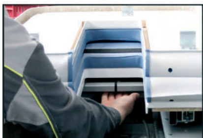
Фото 5. Снятие секций кушетки при техническом обслуживании
