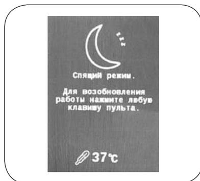
10.2. Обогрев рабочей жидкости Ванны в «спящем» режиме автоматически отключается.
