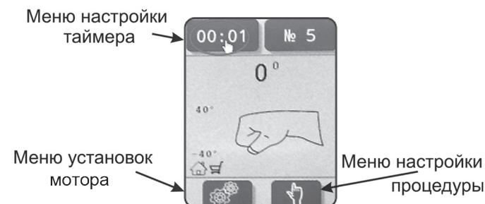
Рисунок 5.4 – Дисплей режима готовности
