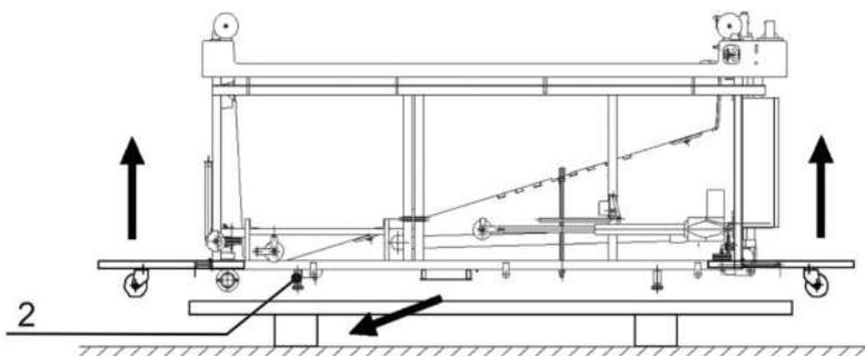
в) установить ванну с рамой на ролики и переместить ее на выбранное место монтажа; извлечь из труб направляющие ролики; опустить ванну 1 рамой на опоры 2, отрегулировать высоту опор
