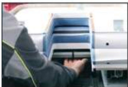
Фото 5. Снятие секций кушетки при техническом обслуживании
