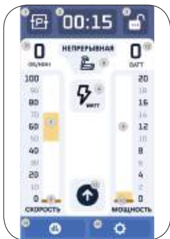
Рисунок 12б – Основной экран ручного пульта управления процедуры велоэргометрии для аппаратов моделей ORMED-Moto MT050, ORMED-Moto MT050 детский.
