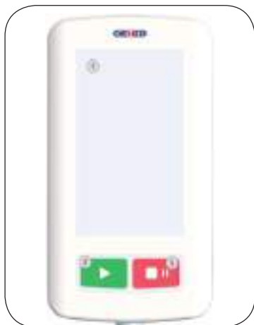
1. Экран сенсорный. 2. Кнопка «Старт». 3. Кнопка «Пауза/Стоп».
