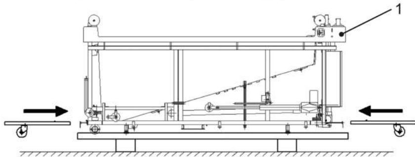
б) поднять ванну с рамой и направляющими роликами над поддоном, извлечь поддон;
