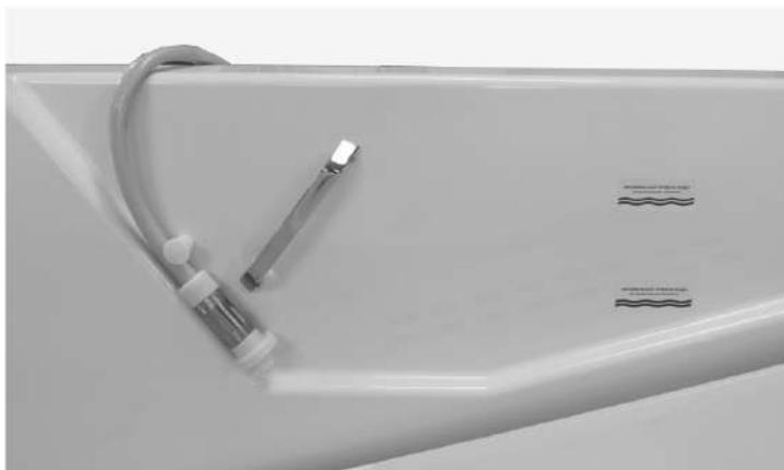
б) Фиксация форсунки ПДМ
