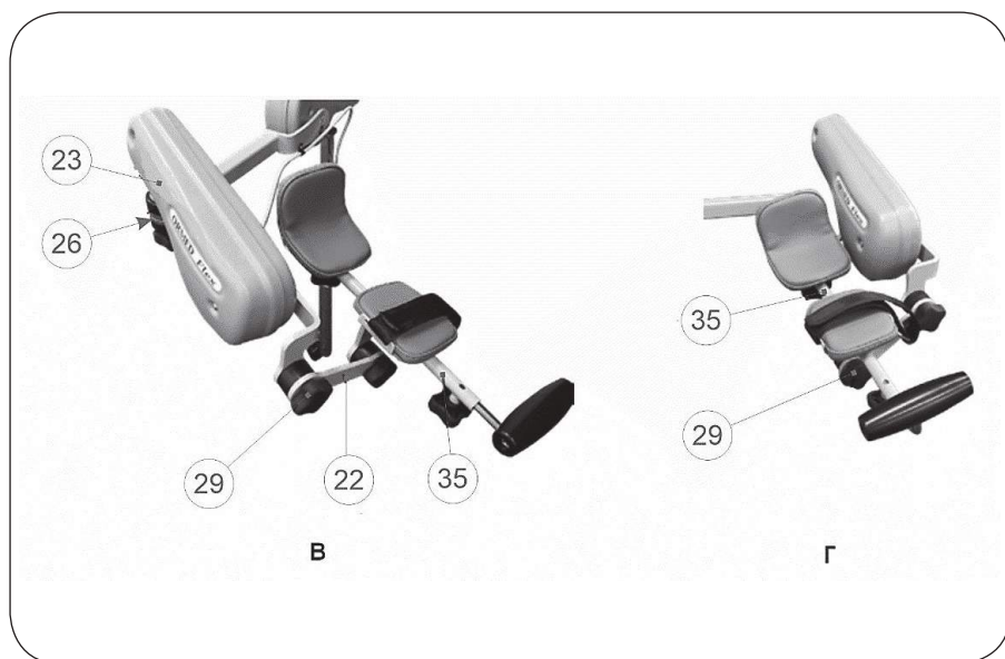
Рисунок 6.1в, г – Установка исполнительного механизма для правой/левой руки
